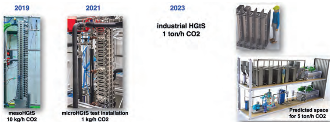
Figura 4 - Evolução das instalações NetMIX para captura de CO 2 (esquerda e centro) e representação esquemática da dimensão prevista para captura de 5 t/h (direita).
